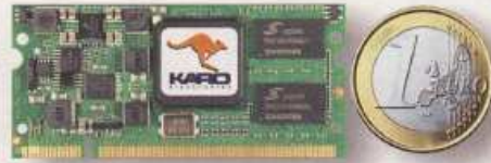
Ka-Ro erschließt mit seinem »TX53«-Modul die Multimediafähigkeiten des Multimediaprozessors i.MX53 von Freescale.
