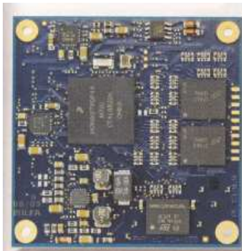
Phytec nutzt für seine »phyCARD«-Module nur die am häufigsten verwendeten Schnittstellen und macht sich damit frei von Prozessorabhängigkeiten.
